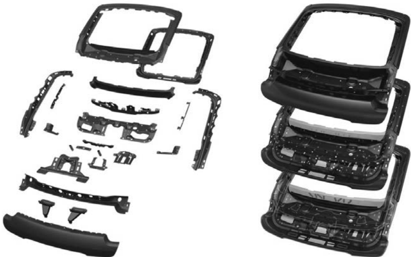
Bild 10: Darstellung der Einzelteile sowie der Fügepunkte und Klebebahnen an der Heckklappe des neuen Panamera
