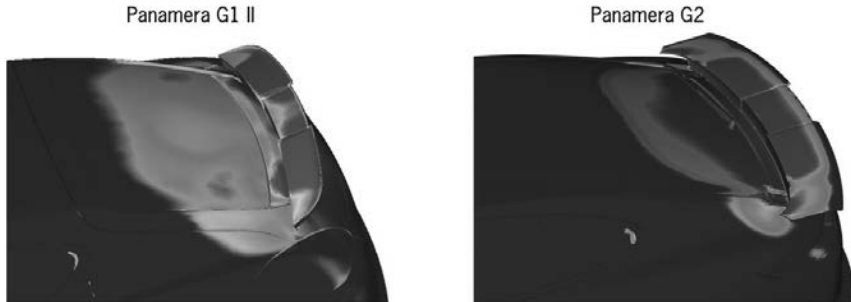
Bild 4: Einfluss des 4-Wege – Spoilers auf die Druckverteilung beim neuen Panamera und seinem Vorgänger (Performancestellung)
