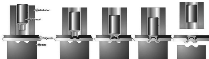
Bild 2: Prozessdarstellung des Halbhohlstanznietens nach [1]
