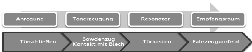
Bild 8: Beispiel: Kette von Effekten zur Geräuscherzeugung
