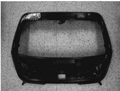
Bild 6: Heckklappen Innenteil mit hinterspritzter Blech- bzw. Organoblechverstärkung
