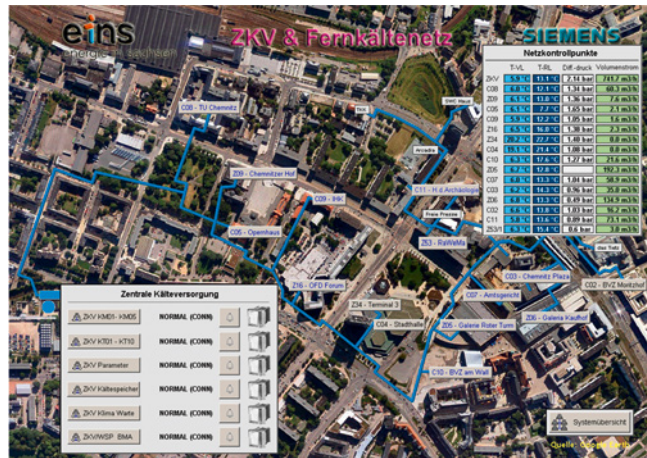
■ Abb. 123: Schematische Darstellung des Fernkältesystems der eins energie in sachsen als Übersichtsbild im Leitsystem mit aktuellen Messwerten der Netzkontrollpunkte, Strahlennetz
