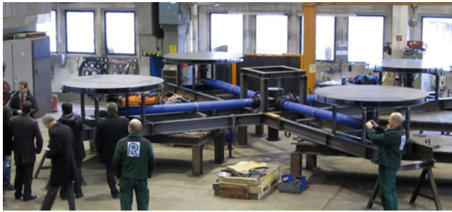
■ Abb. 154: Optimiertes Tragwerk hinsichtlich eines minimalen Materialeinsatzes und einer rationellen Fertigung, Be- und Entlade-system für den 1000 m 3 Kaltwasserspeicher Klinikum Chemnitz, Realisierung durch die Fa. RAC Rohrleitungsbau Altchemnitz
