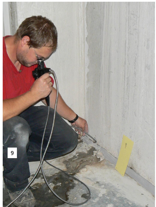
Bilder 8 und 9: Ultraschallprüfung und Endoskopie
