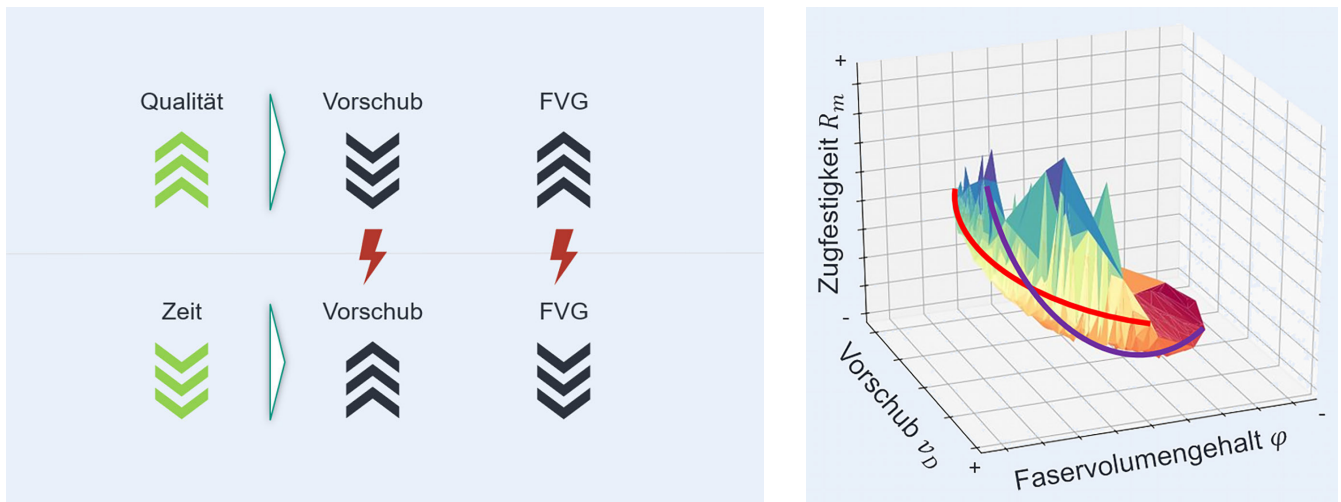
Bild 6. Zielgrößenkonflikt (links) und beispielhafte schematische Darstellung der entstehenden Paretofront mit Isocharakteristika (rot) und Isochrone (lila). Grafik: rechts, KIT/wbk nach Grafik aus [21]
