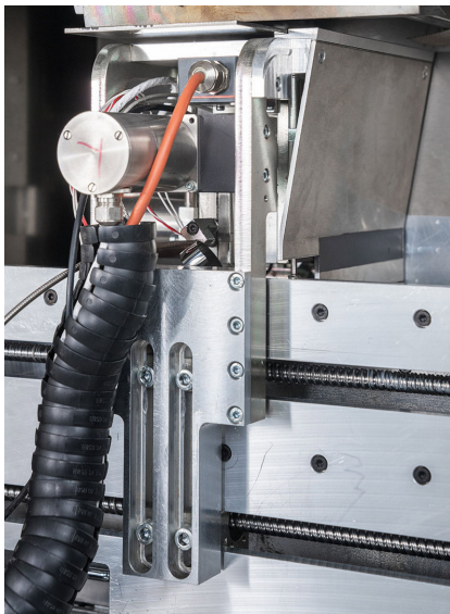
Bild 1. Die entwickelte Faserintegrationseinheit und Prozessschema. Grafik: links, KIT, Amadeus Bramsiepe / rechts, KIT/wbk nach [20]
