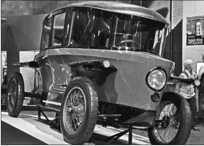
Abbildung 9: Der Rumpler-Tropfenwagen ist noch heute mit seinem Luftwiderstandsbeiwert von 0,28 cw unerreicht im Fahrzeugbau.
