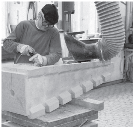
Der Absaug-Rüssel entfernt frischen Feinstaub aus der Luft (Abb. 71)
