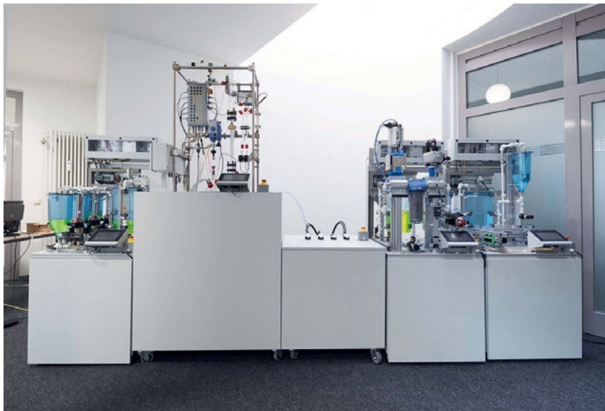
Abbildung 7-2: Modulare Demonstrationsanlage (Vier Module, ein Backbone (Mitte))
