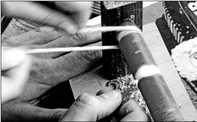
Abbildung 11: Nachvollzug alter Drehtechnik an einem vereinfachten Modell einer alten Drehbank mit hin- und hergehendem Schnurzug. Das Werkstück ist, der Einfachheit halber, hier eine Kerze.
