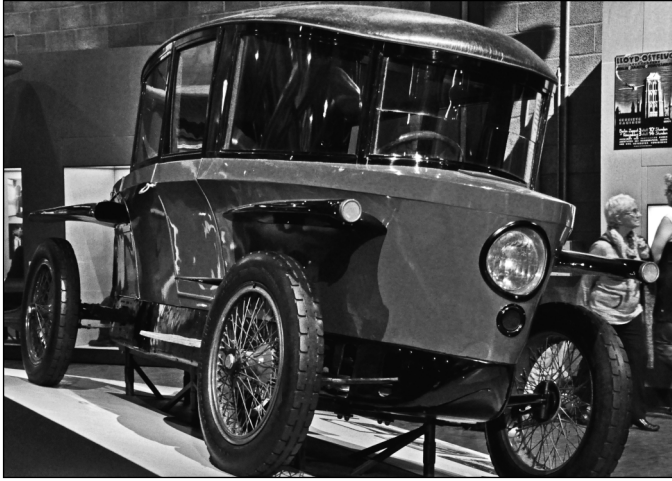
Abbildung 9: Der Rumberg-Tropfenwagen ist noch heute mit seinem Luftwiderstandsbeiwert von 0,28 cw unerreicht im Fahrzeugbau.
