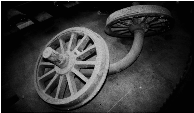
Abbildung 10: Verbogene Achse des Tenders einer Dampflokomotive, um 1900. Die Verbiegung lässt die Kräfte anschaulich werden, die bei der Entgleisung aufgrund von Masse und Geschwindigkeit auftraten.
