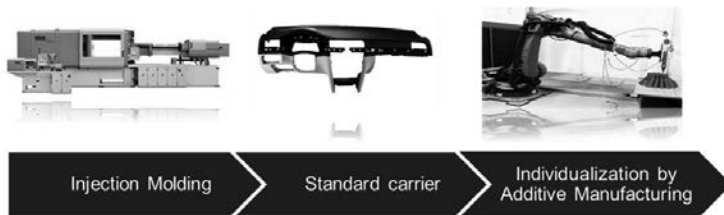
Bild 7: Kombination von Spritzguss und Additive Manufacturing.
