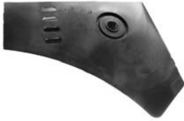
Bild 5: MuCell-Bauteil (Blende) ohne DMH
