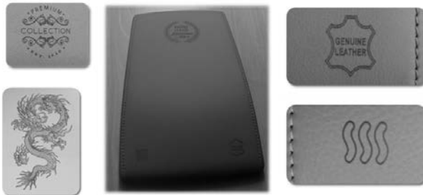
Bild 4: Individualisierte Lasergravur auf einer Lederoberfläche
