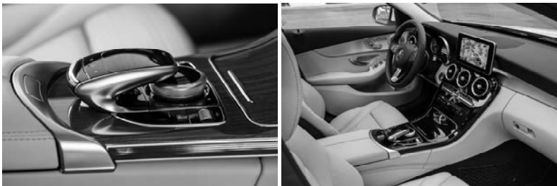
Bild 8: Das neuartige Mercedes-Benz Touchpad mit sphärischer Oberfläche zur Bedienung des COMAND Online System (Fotos: Daimler AG)
