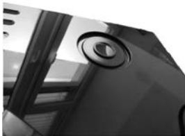
Bild 6: MuCell-Bauteil (Blende) mit DMH erzeugter Hochglanzoberfläche
