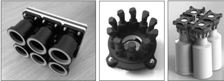
Bild 2: Von links nach rechts: Konventionelle Flaschengreiferlösung, Laser gesintertes und nachträglich gefärbtes Greifermodul, montierte Greifereinheit
