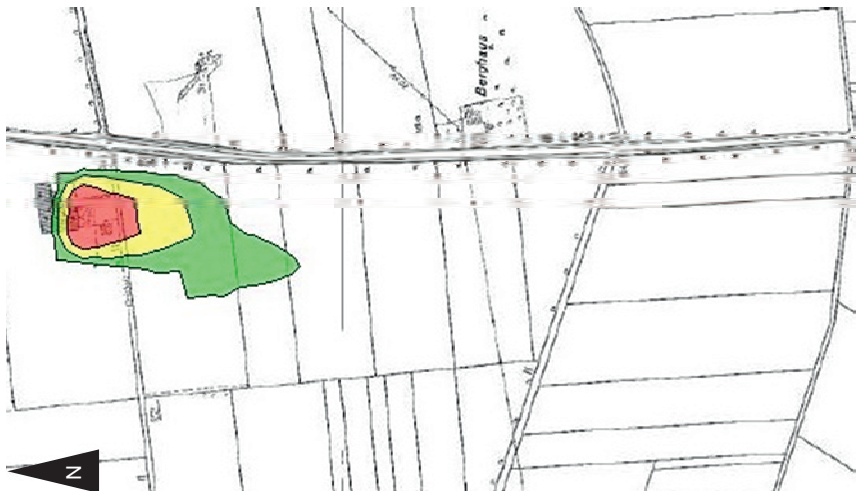
Bild 4: An Hand der Begehungsergebnisse iterativ ermittelte Emissionsfaktoren (Fahnenmodellierung)
