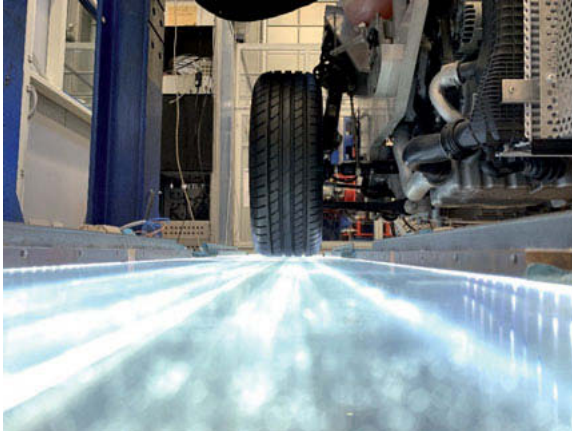
Bild 9: Längsdynamikprüfstand mit transparenter Fahrbahn
