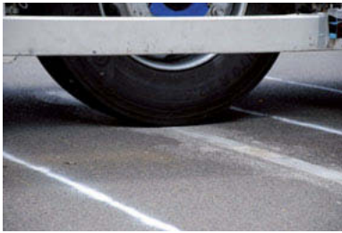
Bild 9: Rad im Moment der Überfahrt des Sensors
