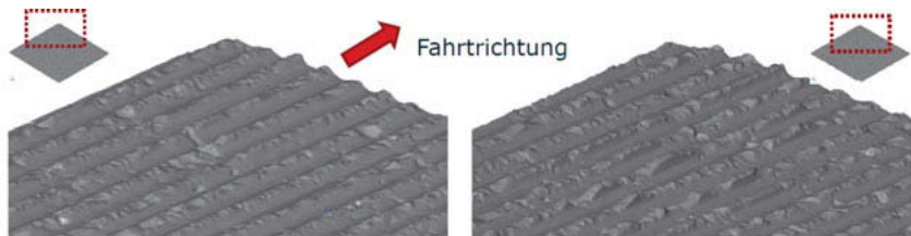
Bild 8: 3D-Aufnahmen Texturgrinding „Typ S“ im Herstellungszustand (rechts) und im Nullzustand (links)
