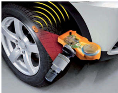
Bild 3: Aktive Reifendrucküberwachung (TPMS), [1]
