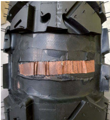
Bild 10: Freigestellte Flex-Platine nach Vulkanisation
