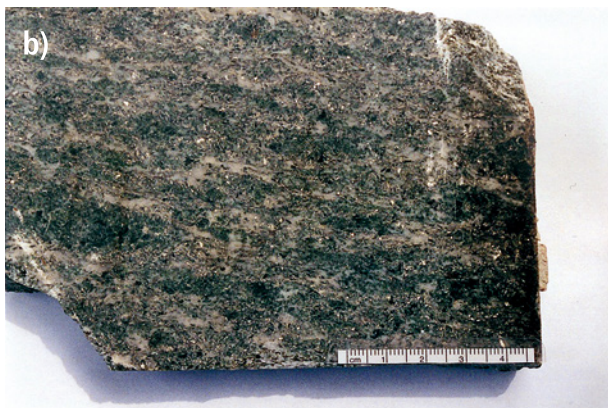
Bild 57a + b ■ Verfärbungen im Fugenflankenbereich von mit elastischem Dichtstoff verfugten Natursteinplatten
