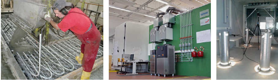
Bild 35: Labor für die Messung der Heiz- und Kühlleistung unter dynamischen Bedingungen: Fertigung der Prüfräume, Laboraufbau am Institut für Energiesystemtechnik und Blick in den Prüfraum mit Fassade zur Klimakammer [Quelle: Hochschule Offenburg]
