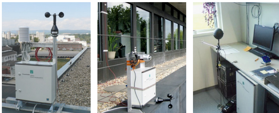
Bild 17: Mobile Messtechnik zur Datenerfassung, -speicherung und -übertragung von Wetter (links), Mikroklima an der Fassade und Raumklima (rechts) [Quelle: Fraunhofer ISE]
