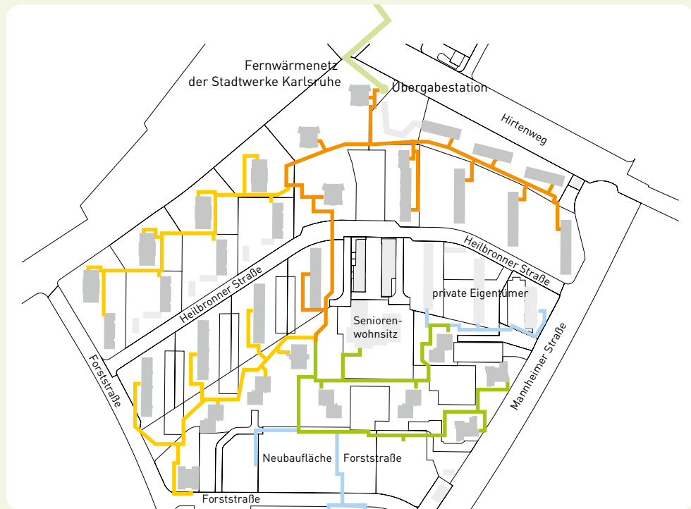
Abb. III-1: Versorgungstrasse (hellgrün) sowie Bauabschnitte zur Errichtung des Nahwärmenetzes Rintheim:
