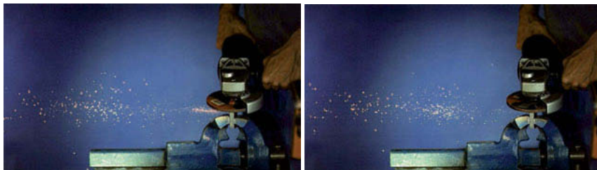
Bild 6: Phänomen „spuckende“ Schrappscheibe in der High Speed–Aufnahme.
