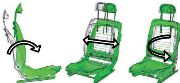
Bild 3: Globale Eigenmoden Sitz: Lehne längs, Lehne quer und Torsion
