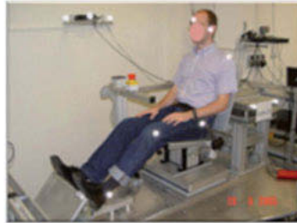
Bild 4: Versuchsaufbau zur Ermittlung der schwingenden Masse eines Probanden
