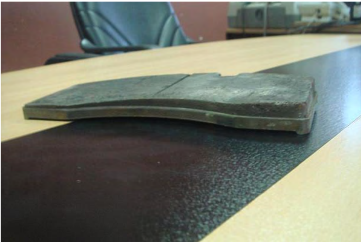
Bild 3: Schrägverschleiß eines Bremsbelags
