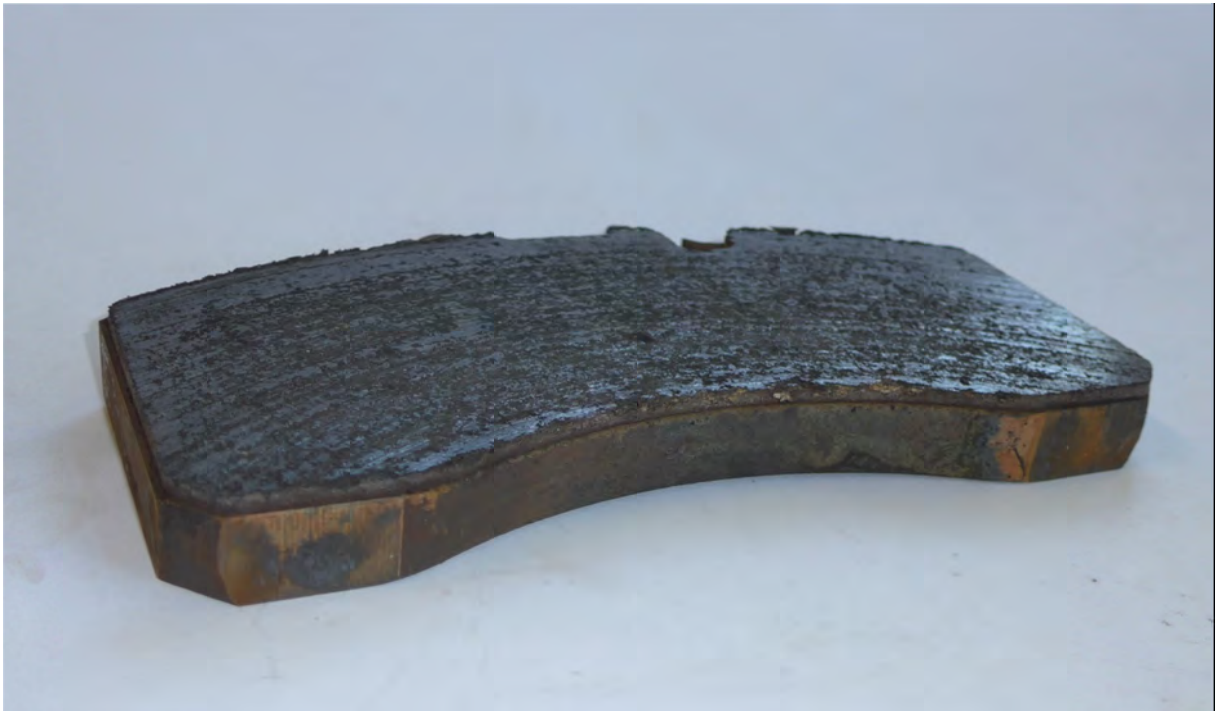
Bild 15a: Beläge nach Abschluss des Fahrversuchs
