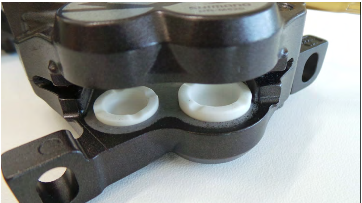
Bild 7: Bremssattel mit unterschiedlichen Kolbendurchmessern
