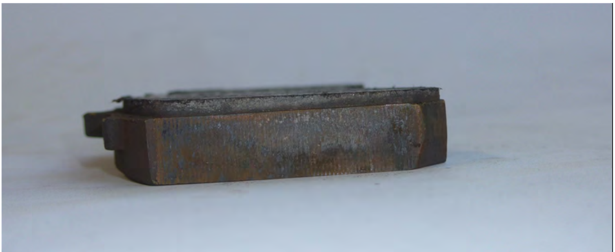
Bild 15b: Beläge nach Abschluss des Fahrversuchs
