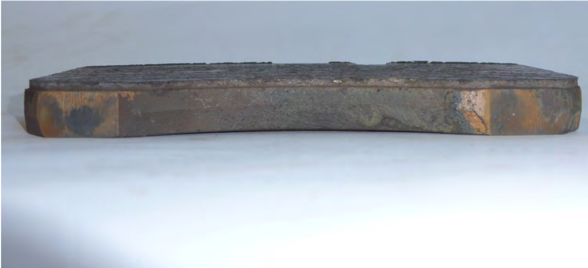
Bild 15c: Beläge nach Abschluss des Fahrversuchs
