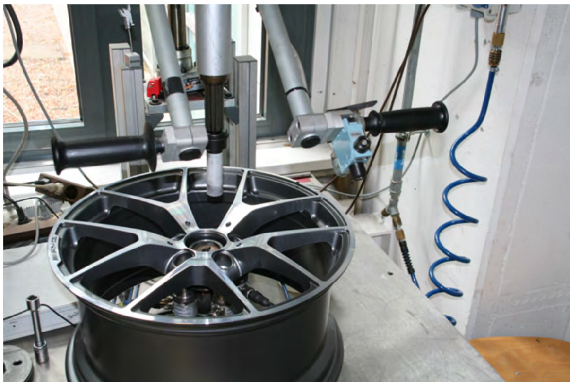
Bild 6: Radverschraubungsprüfstand zur Erprobung und Absicherung des Drehmoment-Vorspannkraft-Verhaltens
