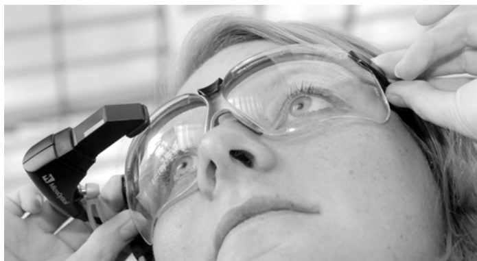
Abb. 8: Head-Mounted Display an einer Schutzbrille (Bild: MRC)
