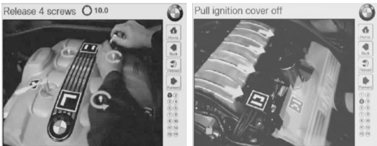
Abb. 4: Beispiele einer Augmented-Reality basierten Reparaturanleitung (© BMW AG).
