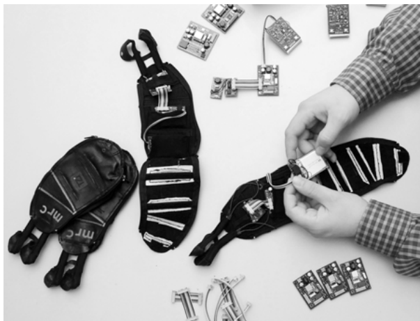
Abb. 7: Komponenten des optimierten Winspect-Eingabehandschuhs, 3. Generation (Bild: MRC)
