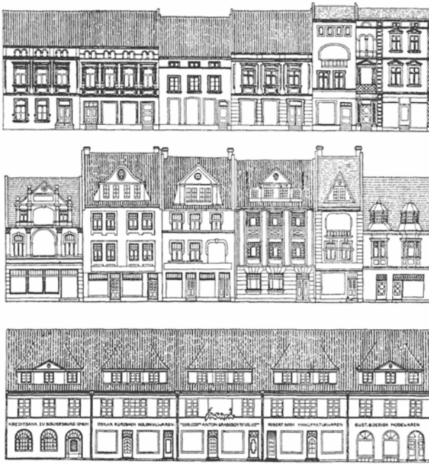
Abb. 42 »Bischofsburg. Häuserreihe an der Nordostseite des Marktplatzes«. 1. Reihe: 1914; 2. Reihe: »Nach den ersten Entwürfen für ihre Wiederherstellung«; 3. Reihe: »Nach dem Wiederaufbau« nach Heimatschutzprinzipien
