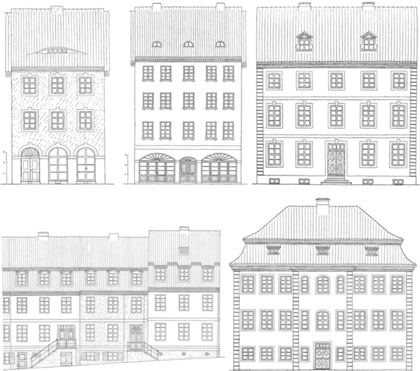
Abb. 39 Idealentwürfe aus den »Grundlagen für das Bauen in Stadt und Land«, Band 2 (Steinmetz 1917). 1. Reihe links: Dreigeschossiges städtisches Wohnhaus mit Ladeneinbau. Durchgehende Drei-Achsen-Teilung. Straßenfront. Mitte: Viergeschossiges Fünf-Achsen-Wohnhaus mit Ladeneinbau. Straßenseite. Rechts: Bürgerhaus in Königsberg. Straßenseite. 2. Reihe links: Reihenhäuser am Neuen Markt in Königsberg. Rückseite der Häuser an der hinteren Querstraße. Rechts: Dreigeschossiges Bürgerhaus in Wormditt. Ansicht Straßenseite
