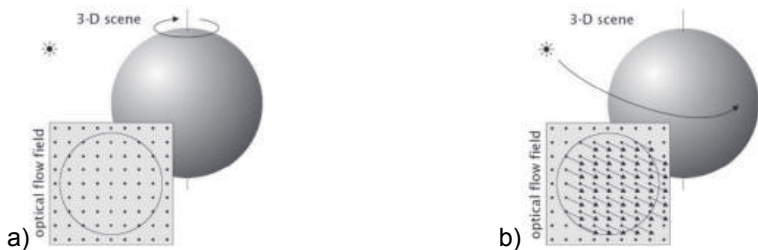
Bild 50: Bewegung und resultierender optischer Fluss an einer Kugel gezeigt, a) Die Kugel bewegt sich: kein optischer Fluss b) Die Beleuchtung bewegt sich: optischer Fluss
