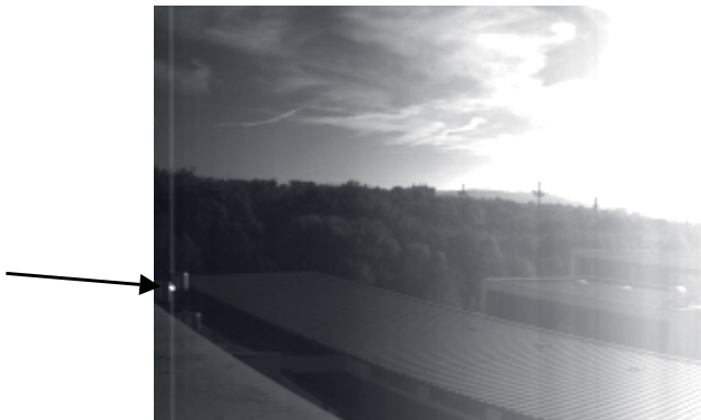
Bild 149: Blooming-Effekt links im Bild
