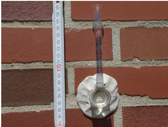
Bild 5: Überprüfung des vorhandenen Schlagregenschutzes, z. B. mit Prüfröhrchen nach Karsten
