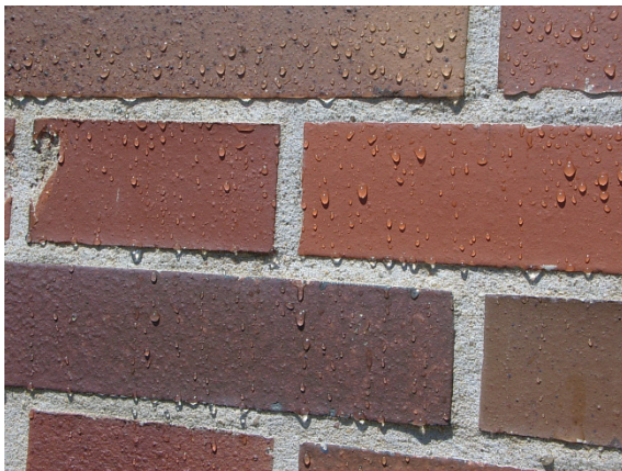
Bild 6: Verifizierung der Schlagregenschutzprüfung mittels Benetzungstest
