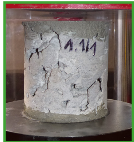
Abb. 6: Kalibrierungsbohrkern; inhomogener Beton, entspricht hier einem B 10 bis B 15
