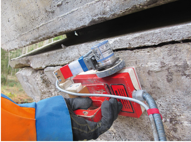
Abb. 4: Der 1,5-GHz-Sensor wird horizontal entlang der Oberfläche geführt.
