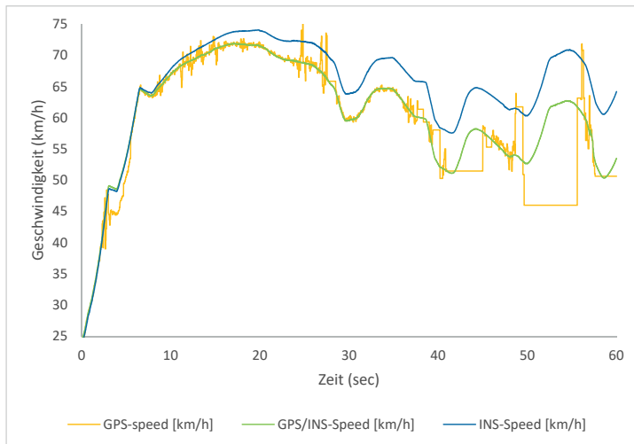
Bild 9: Darstellung der Sensorfusion mittels Kalman-Filter an den Geschwindigkeitssignalen aus der GPS-Messung (gelb), der Inertialsensorik (blau) und dem fusionierten Geschwindigkeitssignal (grün).
