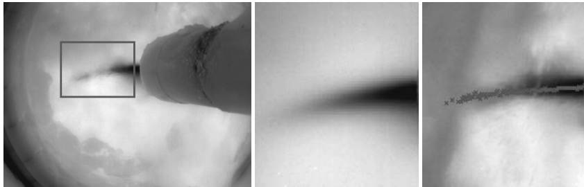
Bild 6: Initiale Streichlinie aus Mittelwertbild. Links: Auswahl des Bildbereiches zur Brennstoffüberwachung. Mitte: Brennstoffbereich nach zeitlicher Mittelwertfilterung. Rechts: Detektionsergebnisse des Brennstoffaufenthaltsortes durch spaltenweise Minimumsuche der Bildgrauwerte.
