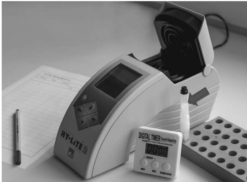
Bild 1: Ausrüstung für die ATP-Messung:- Messgerät mit Wecker und Messstift (roter Pfeil) sowie Protokollblatt
