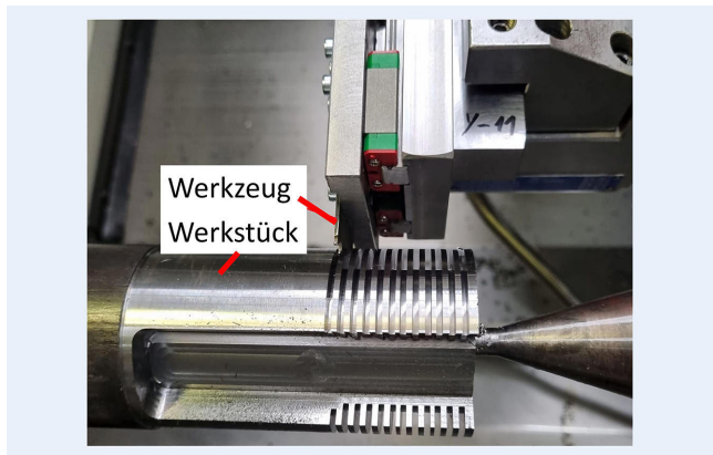
Bild 2. Aufbau Leistendrehtest. Foto: IfW Stuttgart
