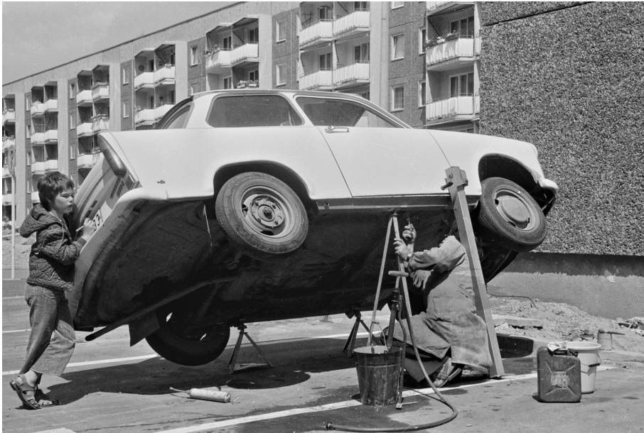
Abb. 2: Reparatur eines Trabant mit Hilfe einer Kippvorrichtung: Hilfsgeräte erleichterten den Besitzern Reparaturarbeiten und sparten Infrastrukturinvestitionen, Fotografie 1969. Quelle: Verlag Peter Kurze, Bremen.
