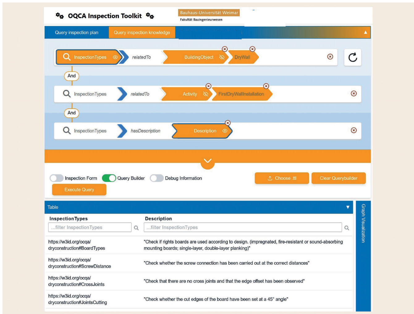
Bild 9. Darstellung der Abfrage und deren Ergebnisse für KF 1 aus Awf 2 innerhalb des Expertensystems als Tabelle. Grafik: eigene Darstellung Fig. 9. Visualization of query results for CQ1 from Use Case 2 within the expert system using a table. Source: own representation
