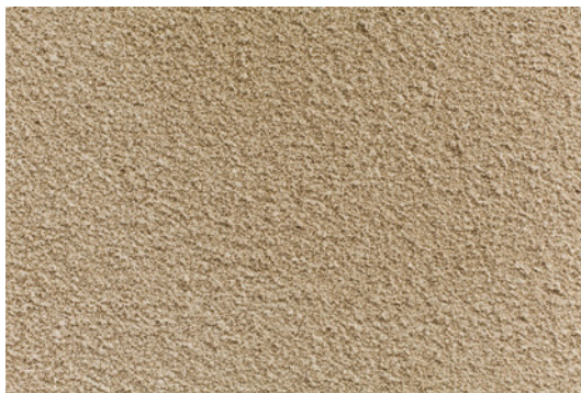
Bild 6: Besenwurf (Rajasil EP WD Besenwurf) Kornbereich: 0–1,5 mm Putzdicke: 3–4 mm
