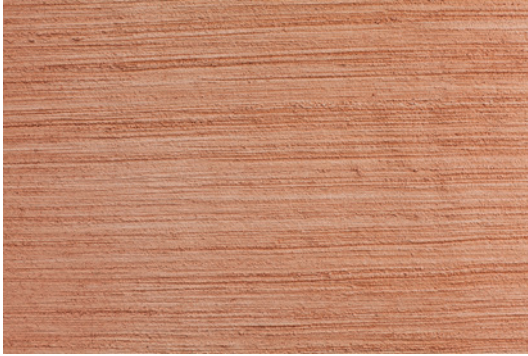
Bild 7: Besenzug (Rajasil EP WD Scheibputz fein) Kornbereich: 0–1,5 mm Putzdicke: ca. 3 mm
