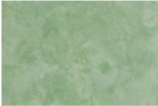
Bild 2: Renaissanceputz (HECK ED Washelputz fein) Kornbereich: 0–0,7 mm Putzdicke: ca. 5 mm
