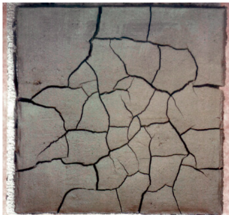
Bild 27: Schwindrisse in einer Lehmschicht von 22 cm × 22 cm Fläche und 1 cm Dicke, aufgebracht auf sägerauem Porenbeton
