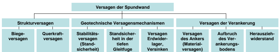
Bild 6.9: Grenzzustände der Tragfähigkeit und geotechnische Grenzzustände für die Schlitzwand.
