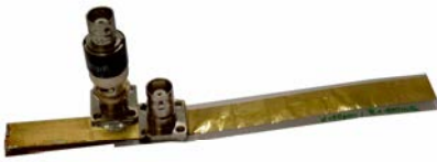
Bild 3.21: Hair-pin-Shunt mit Kompensationsglied. In diesem Fall wurde Messing als Widerstandsmaterial für den Shunt genutzt
