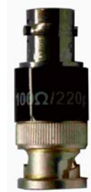
Bild 3.20: Kompensationsglied verbaut im Zwischenbereich einer BNC-Buchse und eines BNC-Steckers
