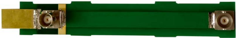
Bild 3.28: Auf einer sechslagigen PCB realisierter PCB-M-Shunt ähnlich dem PCB-M-Shunt mit einem Widerstand von R_{\text{Shunt}} = 5,3 \text{ m}\Omega im Messkreis und einem Widerstand von R_{\text{gesamt}} = 6,5 \text{ m}\Omega im Lastkreis [BöAK18a]. Die Abweichung der Werte R_{\text{Shunt}} und R_{\text{gesamt}} resultiert aus den Übergangswiderständen R_{\text{Kontakt}} zwischen den Mess- und Lastanschlüssen
