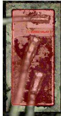
Bild 5.2: Durchlasskennlinien des SiC-BJT FSICBH057A120 von Fairchild (ehemals TranSiC, heute ON Semiconductor) bei T_J = 20\text{ °C} und bei T_J = 150\text{ °C} sowie Fotografie des Chips mit einer Fläche von circa A_{\text{BJT,aktiv}} = 0,0432\text{ cm}^2 nach dem Ätzen mit Schwefelsäure
