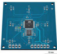
MedTech NTC-Board: Tracking der Temperaturverteilung im Spritzgießprozess
