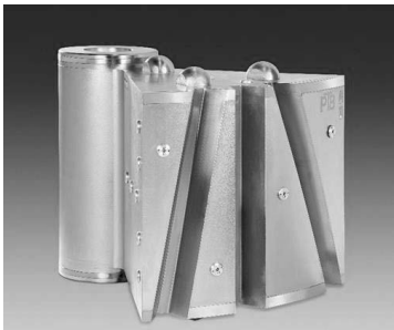
Abbildung 2 – Segmentförmiges Großverzahnungsnormal der PTB
