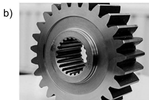
Bild 2: Bauteile mit Passverzahnungen: a) Elastomerkupplung mit Evolventenverzahnung und b) Zylinderrad mit Kerbverzahnung
