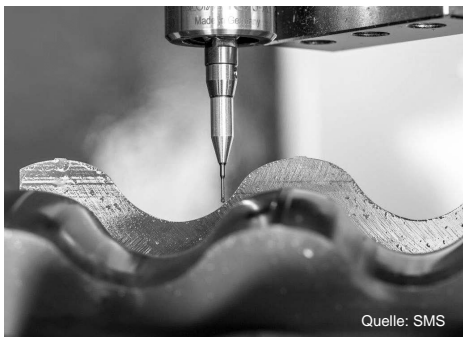
Bild 5: Wälzfräservermessung in der Hinterschleifmaschine
