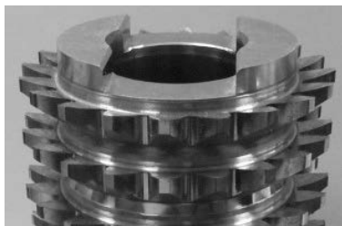
Bild 3: Gerad- und wendelgenutete Räumbuchsen mit Montagenut.
