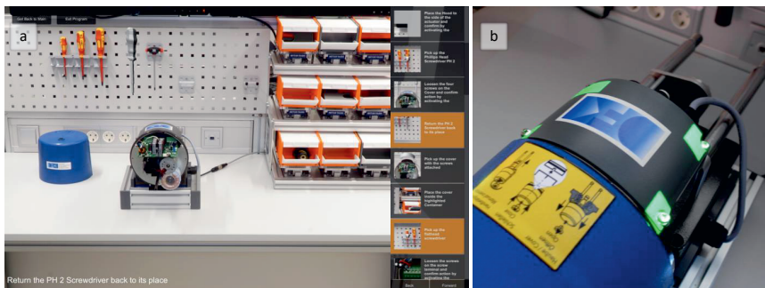
Abbildung 5.3: Visuelle Unterstützung durch monitorbasierte Arbeitsanweisungen (a) und durch eine In-Situ-Projektion (b)
