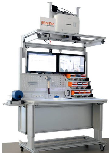
Abbildung 2.7: Handarbeitsplatz mit Assistenzsystem der SmartFactory KL
