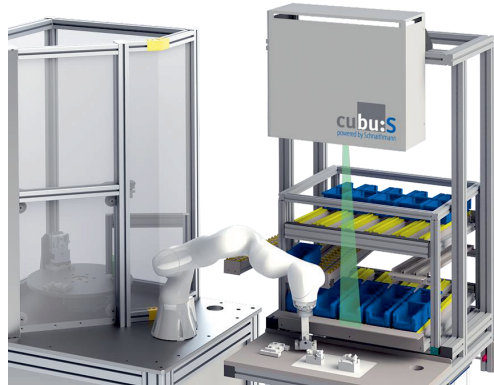
Abbildung 2.5: Werkerassistenzsystem cubu:S für Arbeitsplätze der manuellen Montage (Quelle: [@Schnaithmann])
