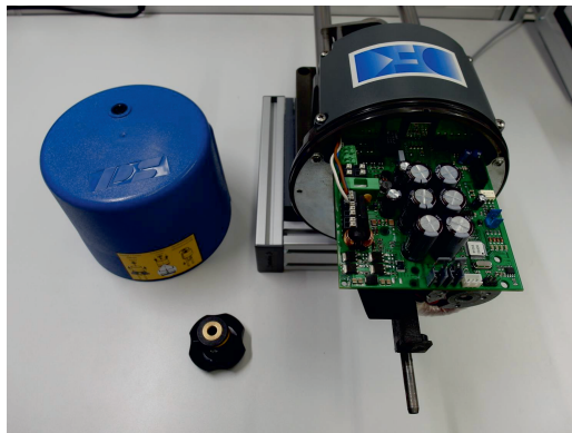
Abbildung 5.1: Stellantrieb in teilzerlegtem Zustand
