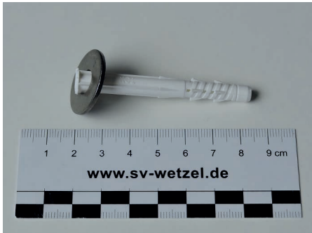
Bilder 53 und 54: Details des Rahmendübels und der Unterlegscheibe sowie des anschließenden Einbaus (1)
