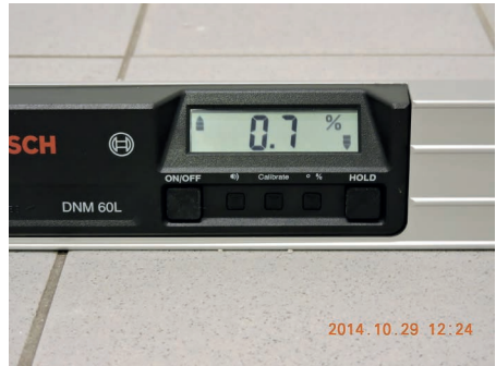
Bilder 2 und 3: Bodenfläche in der Dusche eines öffentlichen Schwimmbads: Statt des erforderlichen Gefälles von 3 % betrug das Bodengefälle nur 0,7 %.
