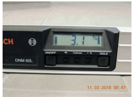
Bilder 12 und 13: Fertiggestellte Bodenflächen der Waschkäue im Duschbereich mit ausreichendem Gefälle: Bei der Ausführung hielt man sich an die Regeln für nassbelastete Barfußbereiche, welche für Duschen ein Gefälle von mindestens 3 % fordern.
