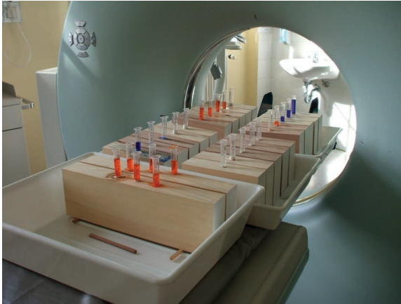
Bild 3: CT-Messung an fehlerfreien Prüfkörpern (200 mm x 120 mm x 50 mm bzw. 400 mm 120 mm x 50 mm; mittig angeordnete Bohrlöcher Ø 10 mm; 80 mm tief) nach der Befüllung
