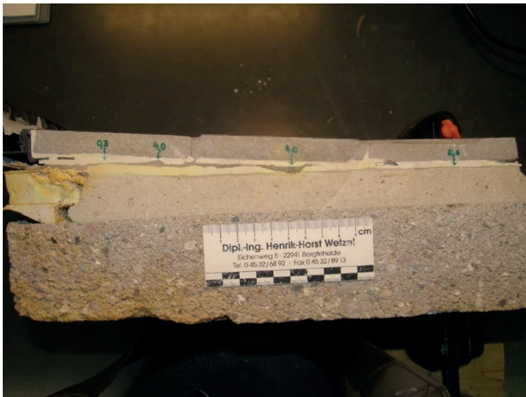
Bild 20: Aus einer mineralischen Dichtschlämme bestehende Verbundabdichtung in den zu den Umkleidereichen gehörenden Duschen einer Schiffswerft: Schichtdickenschwankungen zwischen 0,3 mm und 4,0 mm. Zum Vergleich: Die erforderliche Mindesttrockenschichtdicke gemäß ZDB-Merkblatt u. a. beträgt 2,0 mm.
