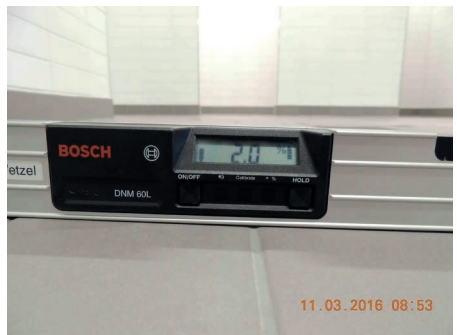
Bilder 14 und 15: An die Duschen der Waschkäue angrenzende, barfußbegangene Bodenflächen ohne Abläufe: Hier orientierte man sich an den Gefälle-Vorgaben, die für Beckenumgänge und Umkleidebereiche nassbelasteter Barfußbereiche gelten („mindestens 2 %“).
