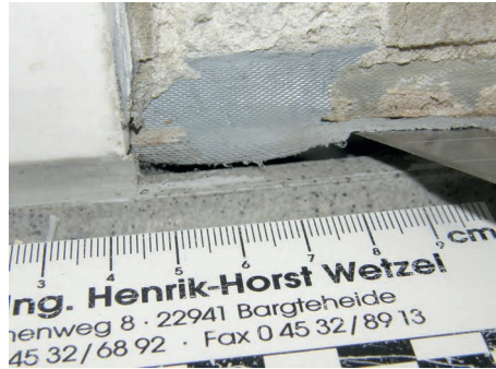
Bild 32: Trotz behutsamen Herausnehmens durchtrenntes Dichtband (Eigenversuch)
