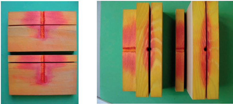
Bild 7: wasserbasiertes Ib-Mittel (Bor angefärbt) Links: Axiale Schutzmittelpenetration in Kiefer 43-77 mm (Splint) bzw. 11-28 mm (Kern) nach 18 Monaten, Rechts: tangentielle Schutzmittelpenetration in Kiefersplint 6-7 mm nach 18 Monaten (rechts); Kern/Splint-Grenze siehe Pfeil [1]
