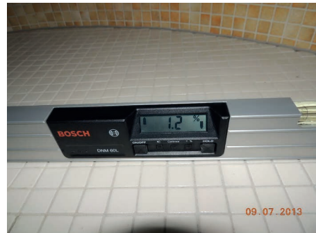
Bilder 4 und 5: Bodenfläche in der Dusche des Saunabereichs eines Hotels: Statt des erforderlichen Gefälles von 3 % betrug das Bodengefälle nur 1,2 %.
