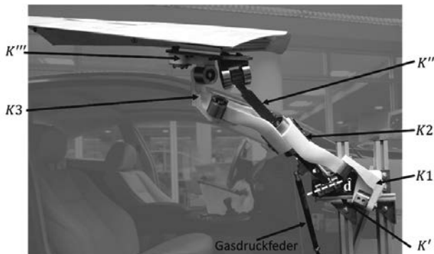
Bild 8: Hybrid gefertigtes Funktionsmodell aus Stahlteilen in Kombination mit lasergesinterten Teilen aus PA2200
