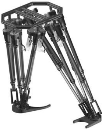
Bild 13: Der Zweibeinschreitroboter mit den Doppelgelenken an den Fußplattformen
