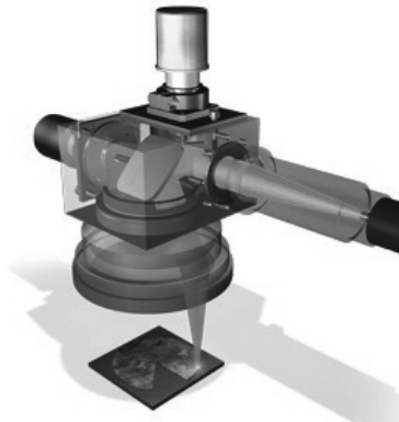
Bild 4: Prinzipdarstellung des Remote-Laserstrahlverfahrens [5]
