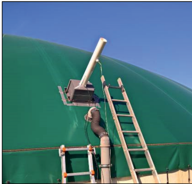
Bild 4: Messung der Methankonzentration am Abluftstutzen eines stützluftgetragenen Doppelmembrandachs.
