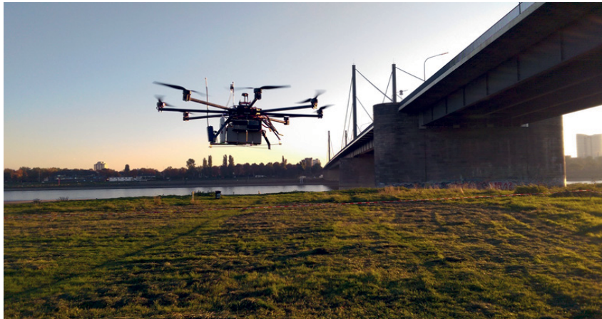
Bild 4: Oktokopter mit Messgeräten bei den Untersuchungen der diffusen Emissionen an der Theodor-Heuss-Brücke.
