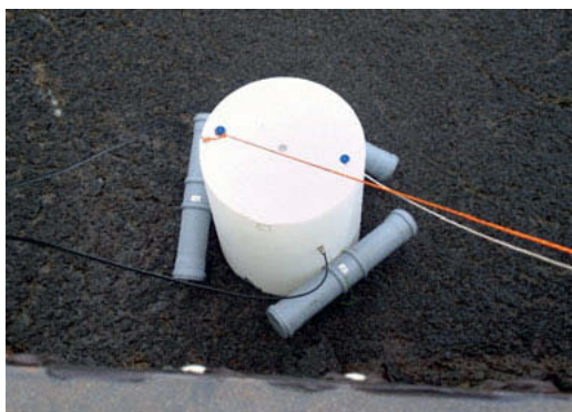
Bild 3: Bestimmung der Methanfracht von einem offenen Gärrestlager unter Verwendung einer geschlossenen Haube (© Torsten Reinelt).
