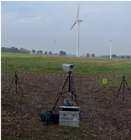
Bild 5: Messung der Methankonzentration auf einer Messstrecke im Abwindbereich einer Biogasanlage mit einem Laserabsorptionsspektrometer (© Tina Clauß, DBFZ).
