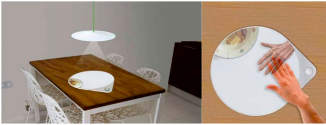
Abbildung 1: Technische Realisierung des Tischbildtelefons mit Webcam, Beamer und Mikrofon (links); Beispiel für die Realisierung virtueller Gestik (rechts)
