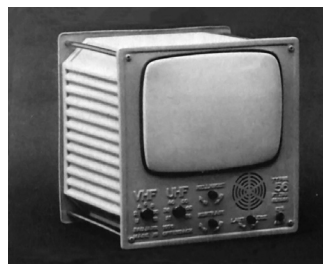
15 Fernsehgerät im Profi-Look: durch Zuganker, Prägeschrift und extrem einfachen Aufbau ...
