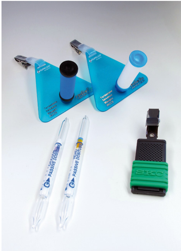
Abbildung 3-8: Verschiedene Passivsammlertypen: Direktanzeigende Probenahme-Röhrchen (links unten), radiello®-Passivsammler (oben) und UMEEx-100 (SKC Inc.) (rechts unten) [Quelle: Fraunhofer WKI, Braunschweig].
