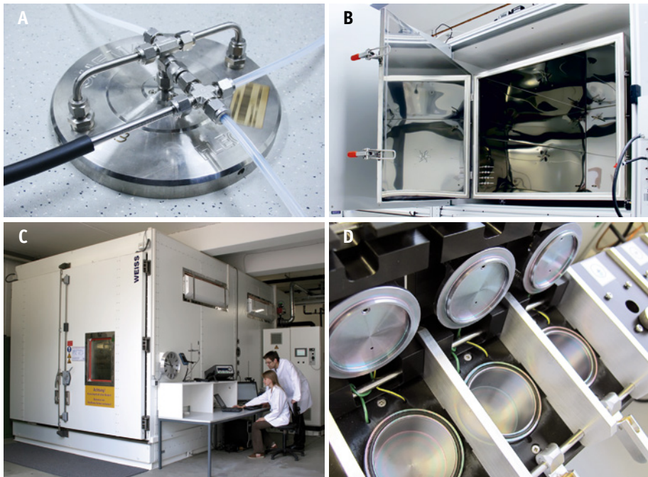
Abbildung 3-7: Verschiedene Prüfkammertypen: A: Field and Laboratory Emission Cell (FLEC); B: 1 m 3 Edelstahlkammer; C: 48 m 3 Edelstahlkammer; D: Mikrokammer [Quelle: Fraunhofer WKI, Braunschweig].
