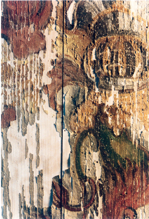
Abbildung 4-9: Weiße Kristallausblühungen auf der Oberfläche eines farbig gefassten Chorgestühls infolge einer früheren Behandlung mit Hylotox® 59 [Foto: Alexandra Schieweck].
