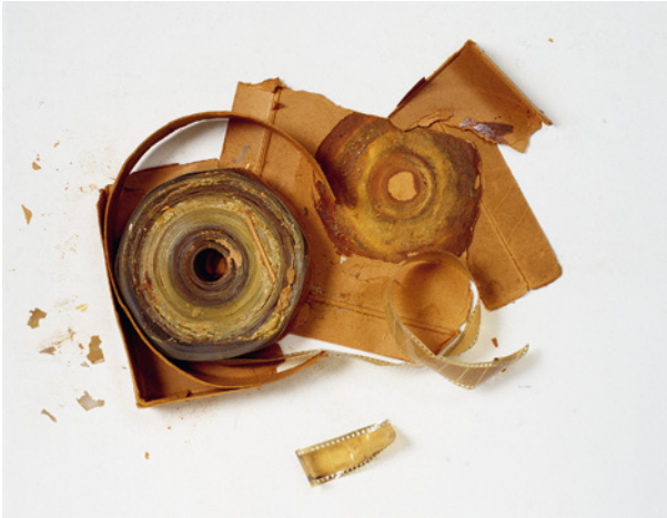
Abbildung 4-6: In einer Schachtel gelagerte Filmrolle, die sich aufgrund des autokatalytischen Zerfallprozesses zersetzt hat [mit freundlicher Genehmigung von Herrn Morten Ryhl-Svendsen, Dänisches Nationalmuseum, Kopenhagen, Dänemark].
