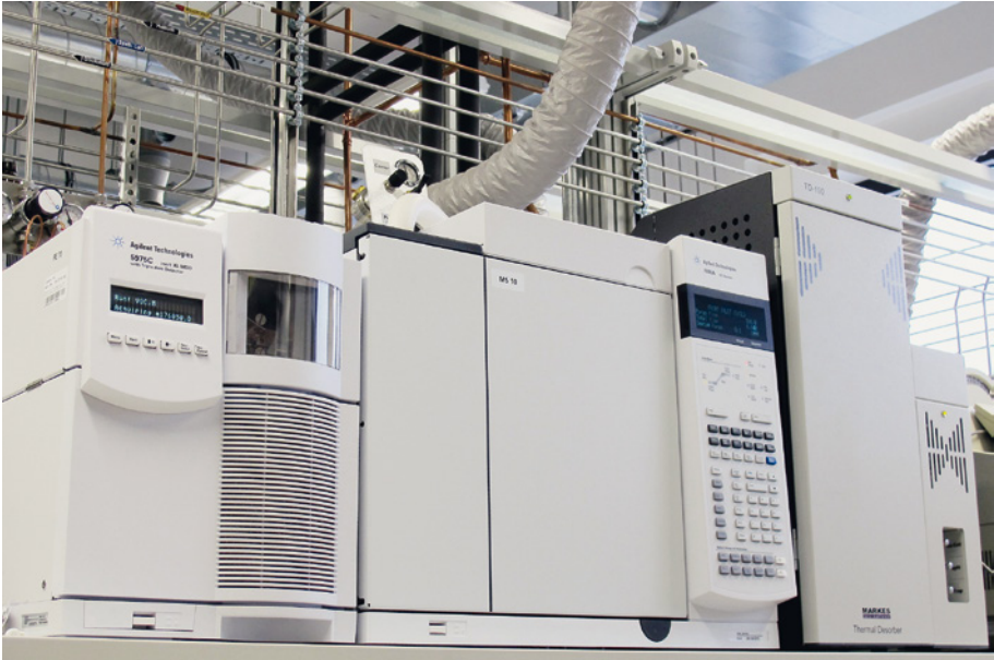
Abbildung 3-5: GC/MS mit Thermodesorptionseinheit [Quelle: Fraunhofer WKI, Braunschweig].
