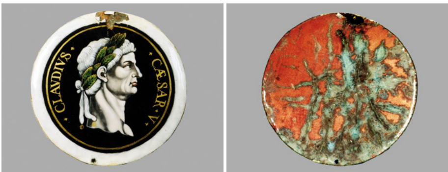
Abbildung 4-4: Medaillon mit Darstellung der Büste des Claudius Caesar V., Mitte 17. Jh., Limoger Maleremail. Die Emailschicht ist am oberen Rand vorderseitig abgeplatzt (links), darunter liegt eine Korrosionsschicht, deren Ausmaß auf der Rückseite (rechts) sichtbar ist [mit freundlicher Genehmigung des Herzog Anton Ulrich-Museums, Braunschweig; Foto: Ursula Gerloff].
