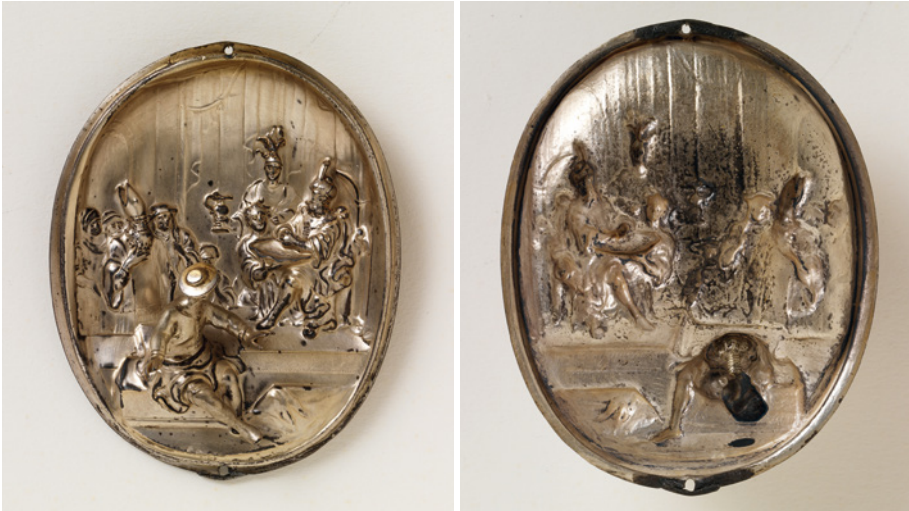
Abbildung 4-3: Medaillon aus Feinsilber, Applikation eines Elfenbeinkreuzes, um 1703. Schwarze Korrosionsschichten auf Vorder- (links) und Rückseite (rechts), insbesondere auf den Höhen der reliefartig gearbeiteten Darstellung [mit freundlicher Genehmigung des Herzog Anton Ulrich-Museums, Braunschweig; Foto: Ursel Gaßner].
