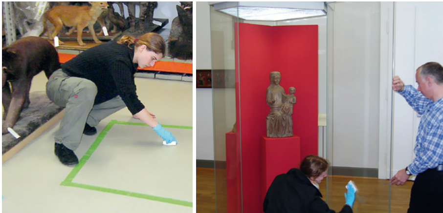
Abbildung 3-6: Entnahme von Wischproben in einem Museum; links: auf dem Fußboden sedimentierter Staub nach 14-tägiger Exposition; rechts: Innenseite einer Vitrine [Quelle: Fraunhofer WKI, Braunschweig].
