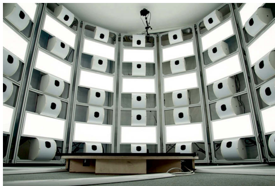
Abb. II.10: Multikamerasystem 3D-Fotobox, Forensisches Institut Zürich Quelle: 3DZZ, Kriminalistik 2/2021
