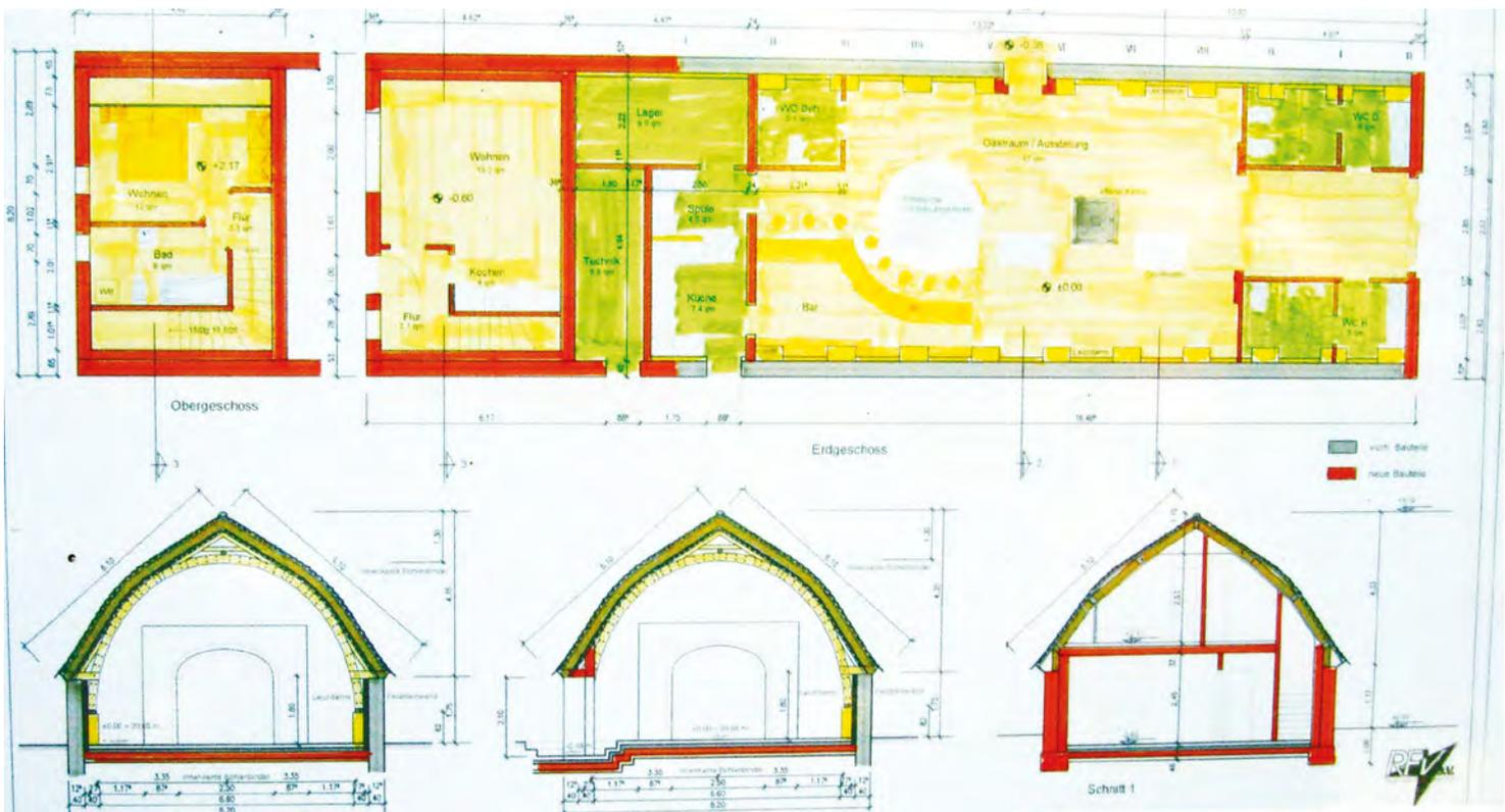
Abb. 9.47: Grafenbrück, Magazin der ehemaligen königlichen Wasserbauinspektion, Grundriss und Gebäudeschnitte (Tafel vor Ort, August 2009).
