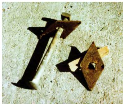
Abb. 13.2: Schraubbolzen  $\varnothing$  14 mm und rhombische Unterlegescheiben mit umgebogenen Spitzen, die in die Lamellen gedrückt werden
