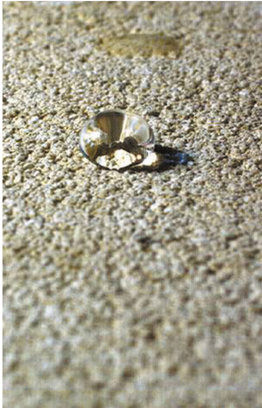
Abb. 47: Ein Wassertropfen wurde auf eine der Fassade entnommenen Probe aufgesetzt. Sichtbar ist der große Randwinkel des Wassertropfens, was die wasserabstoßende Eigenschaft bestätigt.
