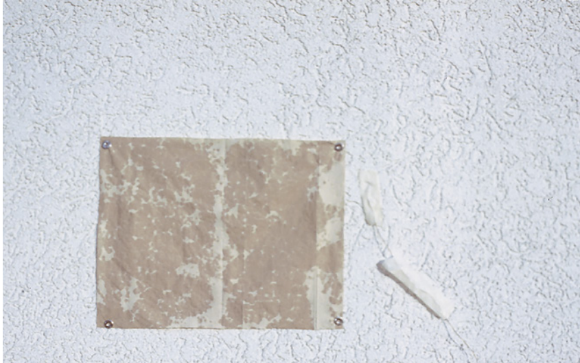
Abb. 28: Das Kondenswasser auf der Oberfläche des Verputzes ist praktisch unsichtbar. Erst beim Aufdrücken eines saugfähigen Papiers wird die Feuchte durch dunkle Flecken auf dem Papier sichtbar.
