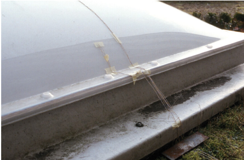
Abb. 66: Temperaturfühler an der algenfreien, dem Gebäude zugewand- ten Seite
