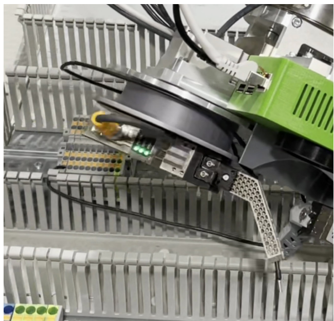
Bild 4. Reihenfolge der Kabelmontage: Das Kabel wird an der Klemmleiste montiert (a). Dann wird das Kabel in den Kabelkanal (b) und (c) geführt. Innerhalb des Kanals wird das Kabel zum nächsten Bauteil geführt (d). Fotos: LPS, Ruhr-Universität Bochum
