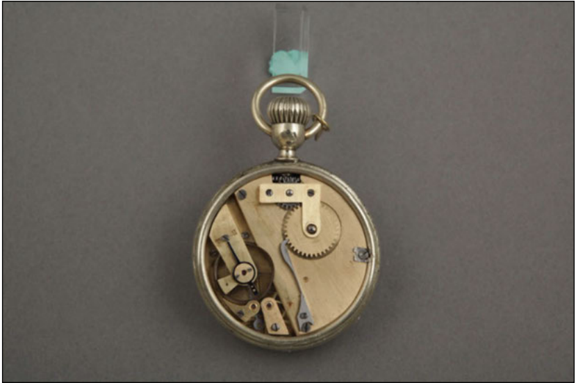
Abb. 5a: Roskopf-Bewegung mit Klinke aus einem Stück.
