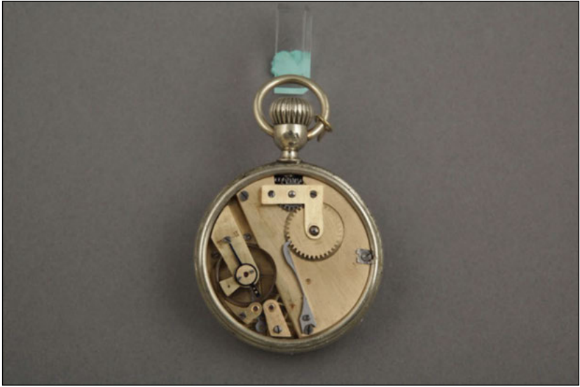
Abb. 5a: Roskopf-Bewegung mit Klinke aus einem Stück.
