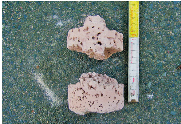
Bild 14 ■ Entnommene Bohrkern zur Bestimmung von Bauteilaufbauten, hier der Anordnung und Abmessung von Kammer- und Stegbereichen eines Leichtbeton-Hohlblock-(Hbl-)Mauerwerks
