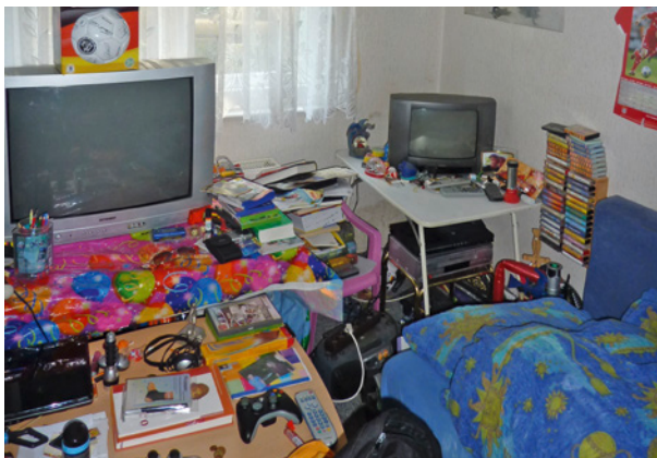
Bild 56 ■ Zur Durchführung regelmäßiger Stoßlüftungen ungeeignete Möblierung und Raumausstattung im unmittelbaren Fensterbereich
