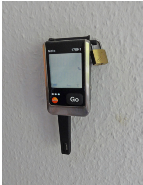
Bild 39 ■ Mit einem Schloss gesicherter Datenlogger für die Aufzeichnung von Raumlufttemperatur und relativer Raumluftfeuchte
