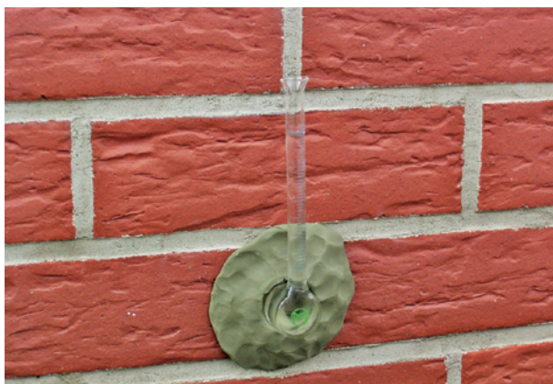
Bild 12 ■ Messung des Wassereindringwiderstands einer Fassadenoberfläche mit dem Karsten'schen Prüfrohr
