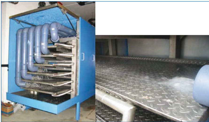
Abbildung 31: Wärmeübertrager für offene Strömung, Nutzwassermenge ab 1 l/s [Fotos: Firma Bernhard FERCHER, Graz, www.fercher.at ]
