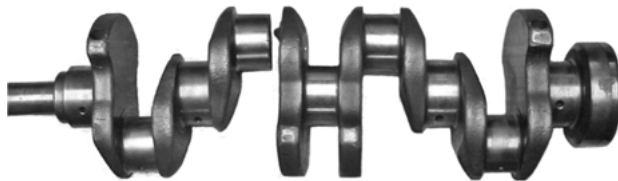
Abbildung 2-8: Biegedauerbruch einer Kurbelwelle nach [FLR+13]
