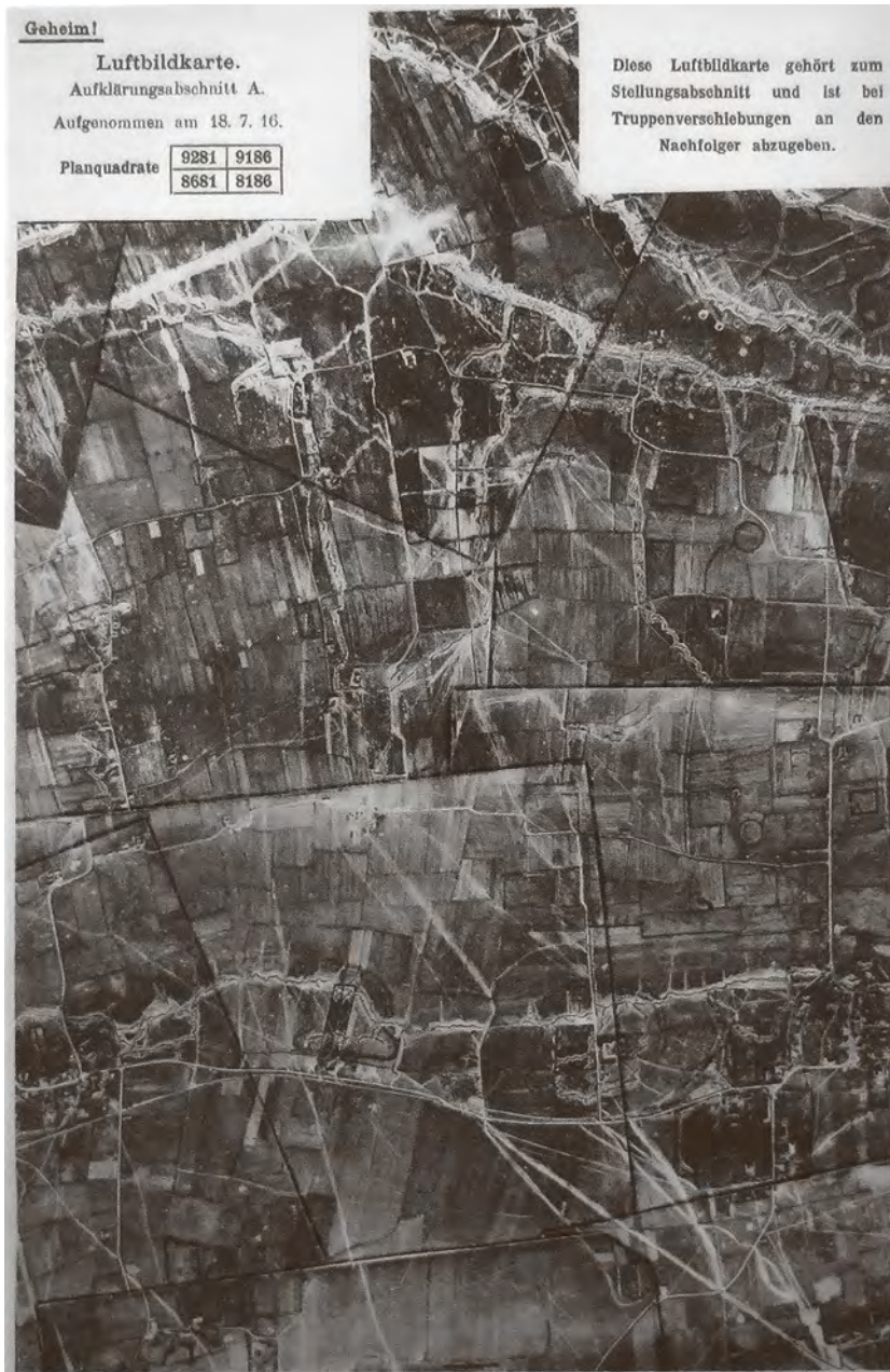
Abb. 13 Luftbildkarte »Aufklärungsabschnitt A«, 18.7.1916 (zehn montierte Fotografien, die ursprünglich schräg aufgenommen wurden; anschließend wurden sie in Bildauswertern entzerrt, um sie aus Ermangelung geeigneter Detailkarten als senkrecht aufgenommene Bilder der Landschaft zu nutzen)
