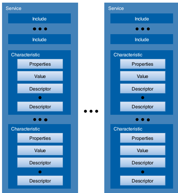
Abbildung 7 Struktureller Aufbau der des Bluetooth LE Generic Attribute Profiles
