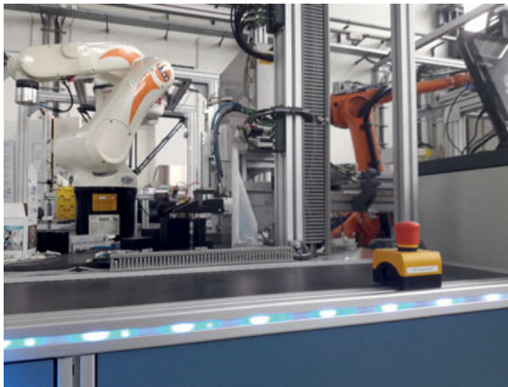
Abbildung 3 Beispiel für Calm Design in der Werkstatsumgebung: Integrierte Leuchtelemente in der Anlage
