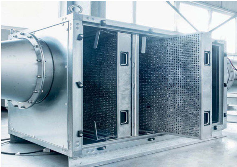
Bild 4: Pelletmodul mit drei Einschubkassetten
