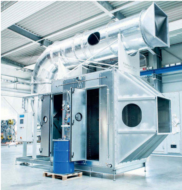
Bild 2: Geruchsbehandlungsanlage für 40.000 m 3 /h Abluft (Glasrecycling)
