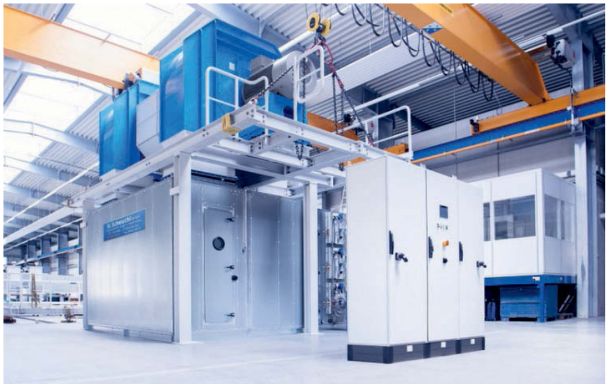
Bild 1: Geruchsbehandlungsanlage für 160.000 m 3 /h Abluft (Gießerei)
