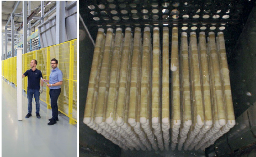
Bild 4: Filterkerzen - Kernkomponente der CCF-Technologie
