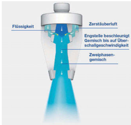
Bild 5 : Schematische Darstellung einer Lechler Laval Düse
