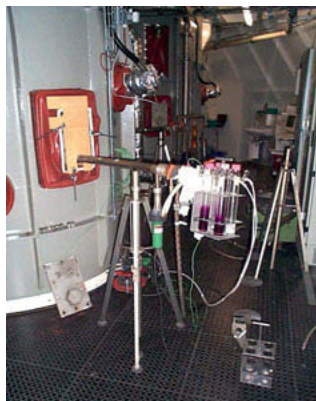
Bild 3: Manuelle Quecksilbermessung nach DIN EN 13211
