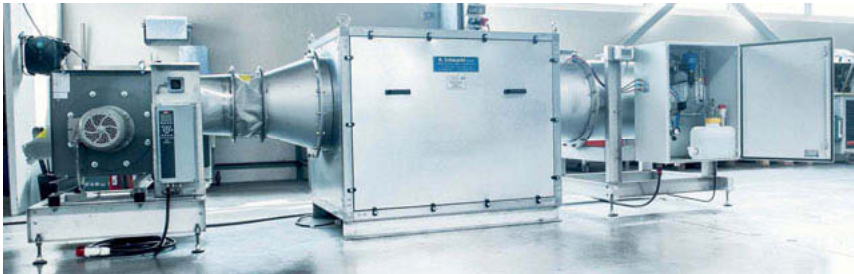
Bild 3: Kombinierte Geruchsbehandlungsanlage, bestehend aus Ventilator-, Pellet- und Düsenmodul
