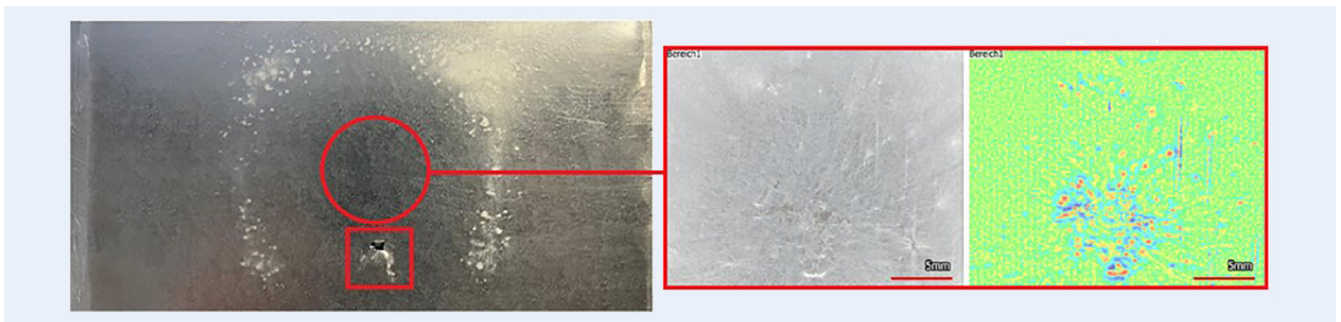
Bild 7. Ringförmige Eruptionen nach hoher Erwärmungsdauer. Foto: LUH (IFUM)
